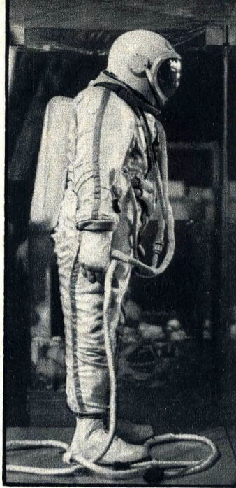
Der Raumanzug Leonows für den Ausstieg ins All. Charakteristisch für diesen Skaphander ist die „Nabelschnur“, die den Kosmonauten mit dem Raumschiff verbindet.
