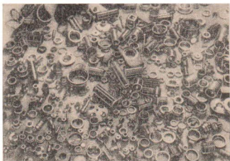
137/1 Sortiment der Teile, für die technologische Arbeitsablaufpläne ausgearbeitet werden müssen, ohne Gruppenbildung
