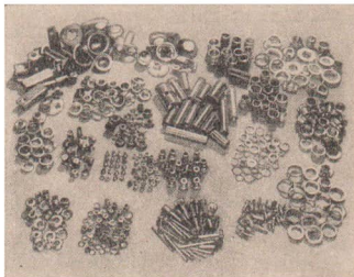
137/2 Sortiment derselben Teile mit Gruppenbildung, wobei alle geometrisch ähnlichen und etwa gleich großen Teile zu einer Fertigungsgruppe zusammengefaßt sind, für die eine Gruppentechnologie und ein gemeinsamer technologischer Arbeitsablaufplan ausgearbeitet wird
