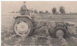
79/1 Geräteträger RS 09 mit Maishackgerät und Düngerstreuer
