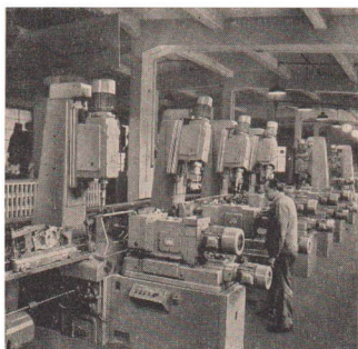
98.2 Automatische Fertigungsstraße aus Aufbaueinheiten zur Bearbeitung von Motorrad-Kurbelwellengehäusen.
