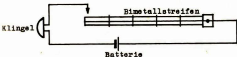
**Begründung:** (Der Bimetallstreifen muß so eingesetzt werden, daß er sich bei Erwärmen zum Kontakt hin krümmt und den Stromkreis schließt. Deshalb ist Aluminium unten und Eisen oben anzuordnen.)
