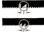
Bild 5 Unterschiedliche Teilung ergibt unterschiedliche Spanräume
