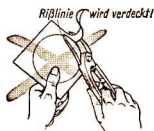
Bild 9 So wird die Handblechscherer richtig gehalten
