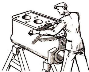
Bild 3 Entgraten eines maschinell bearbeiteten Werkstückes
