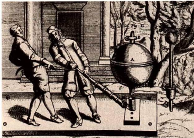
Abb. 2.5.5./1 Guericques Experiment zum Auspumpen einer Kupferkugel
