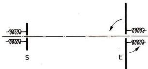
Abb. 2.16.2./3 Experimentelle Anordnung zur Polarisation Hertzscher Wellen
