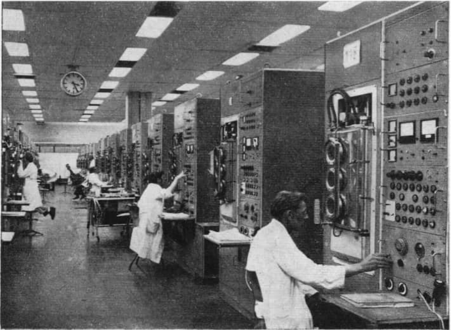
Abb. 5.20 Zonen-floating-Apparaturen zur Produktion von Halbleitersilicium im VEB Spurenmetalle, Freiberg (Typ ZFA 69, hergestellt im VEB Steremat, Berlin; Aufnahme: KASTEX)
