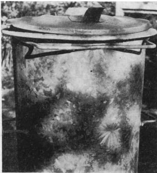
Abb. 2 Kristalle auf einem neuen feuerverzinkten Müllbehälter
