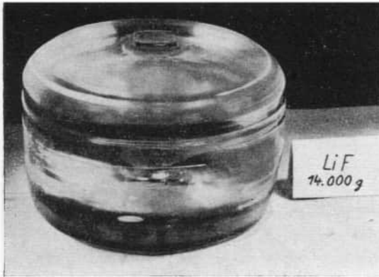
Abb. 5.13 Kristall von Lithiumfluorid (14 kg; gezüchtet im Institut Monokristaly, Turnov, ČSSR)
