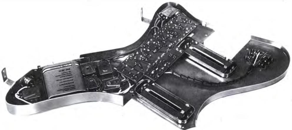
**Bild 19.22.** So sieht die vollständige Gitarrelektronik II aus
