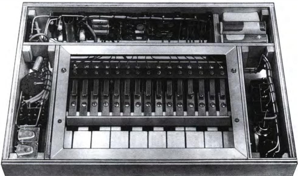
**Bild 18.14.** So sieht die Elektronenorgel von unten aus
