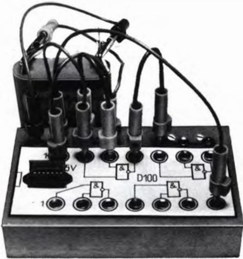
Bild 17.16. Das IS-Experimentiergerät
