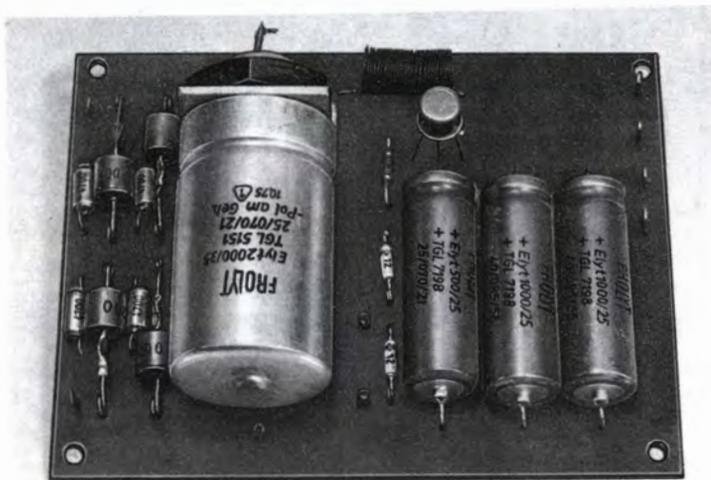
Bild 5.17. Unser Leistungsregelnetzteil LR
