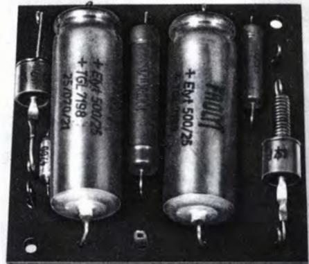
**Bild 3.8.** Die Gleichrichterschaltung von der Leiterseite und von der Bauelementeseite
