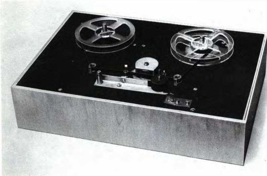
Bild 15.23. Experimentierlaufwerk mit aufgelegtem Band
