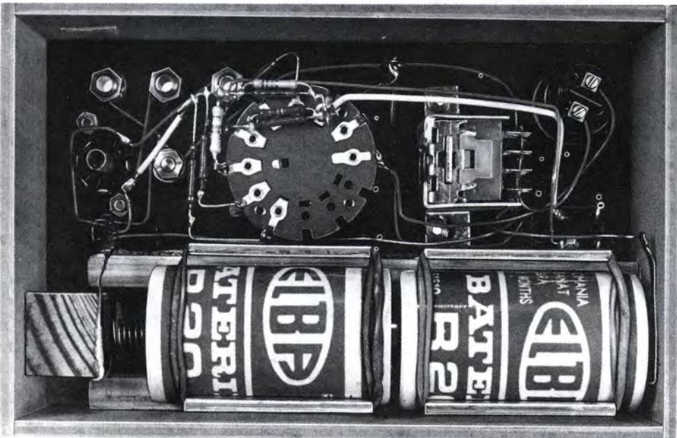
Bild 4.4. Blick in die Verdrahtung des Dioden-Transistor-Meßgerätes
