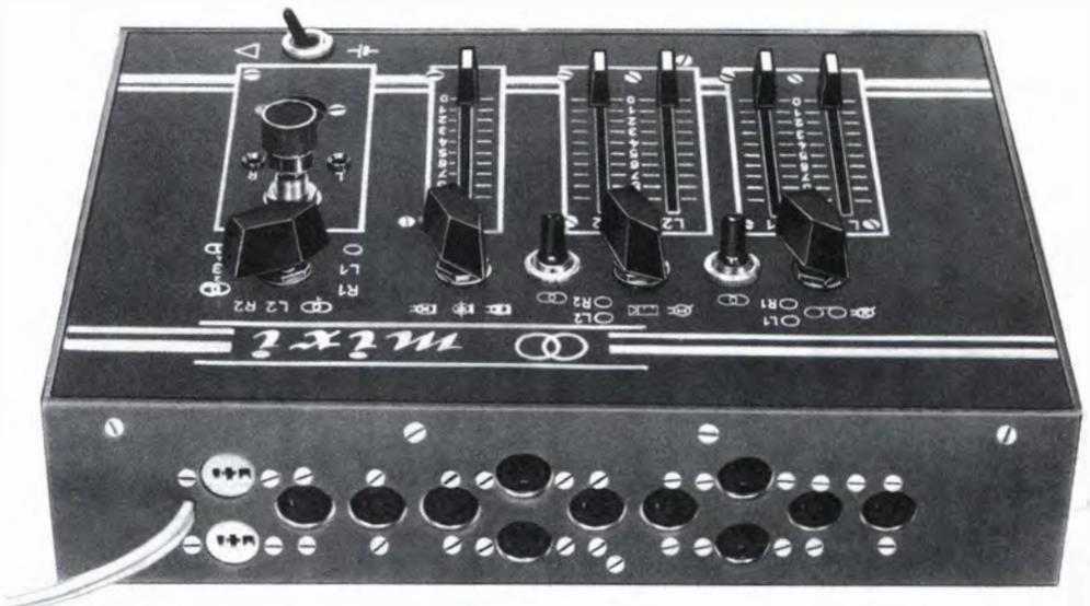
Bild 13.19. Die rückseitigen Eingänge und Ausgänge des Mischpultes
