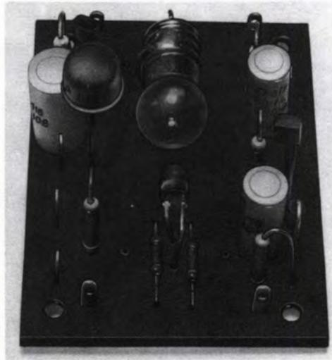
**Bild 18.23.** Der Tremoloverstärker ohne Lichtkasten
