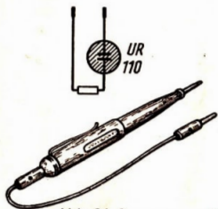
Abb. 96 Spannungsprüfer mit Schaltbild
