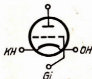
Abb. 50 Triode mit Stiftsockel
