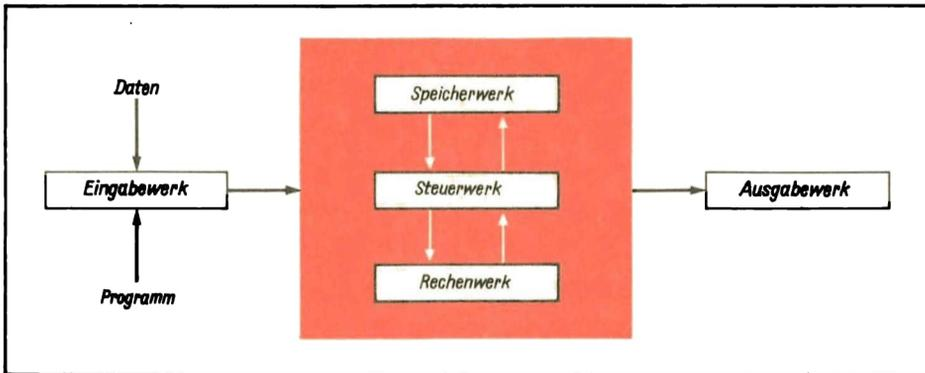
Schema zum Bau und zur Arbeitsweise eines programmgesteuerten Computers
