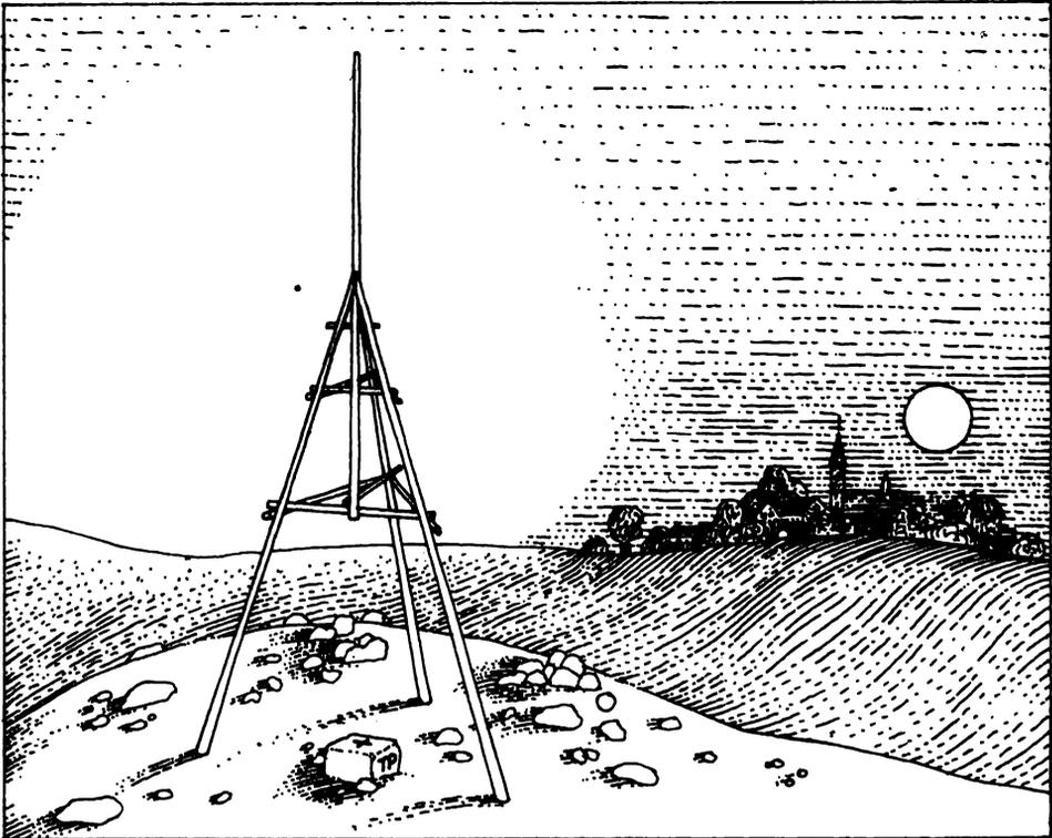
Eckpunkt eines Dreiecks zur Landvermessung (TP = trigonometrischer Punkt)
