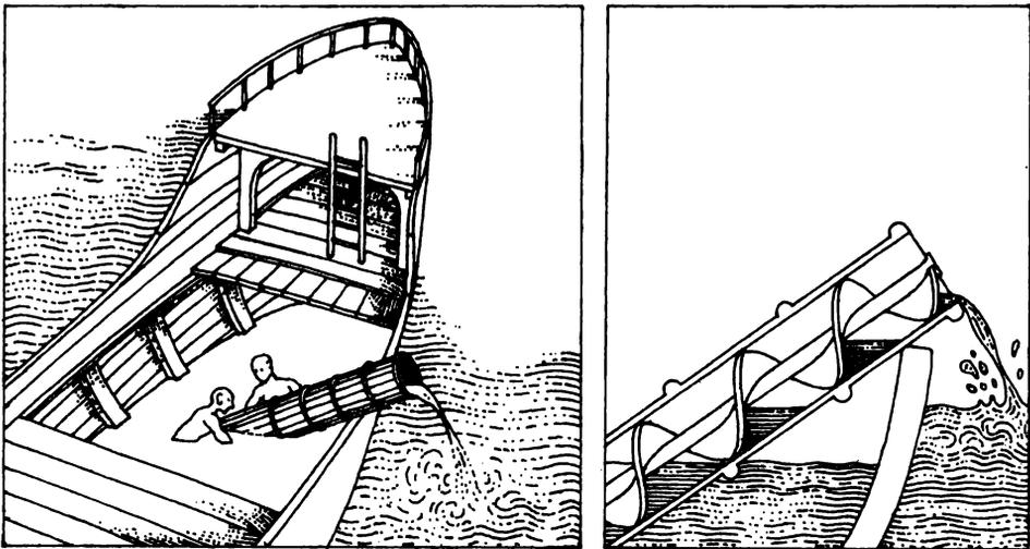
Von Archimedes konstruierte wasserschöpfende Spirale
