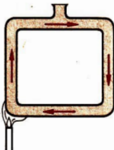
Bild 6.32 Versuch zur Wärme- strömung
