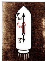
Bild 3.7 Schubkraft F_{\text{Sch}} und Gewicht G greifen als Gegenkräfte mit ungleichen Beträgen an einem Körper an. Für den Betrag der Resultierenden gilt:
