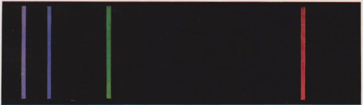
Bild 12.2.2. Schema eines Linienspektrums (Balmer-Serie des Wasserstoffs)
