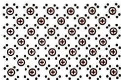
Bild 12.20 Ideales Germanium-Kristallgitter (schematisch). Die Punkte stellen die Elektronen der äußeren Schale dar
