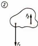
Bild 3.62 Bildung der Resultierenden von Kräften mit parallelen Wirkungslinien. 1. Gleiche Richtung: Durch Einführen der Hilfskräfte F_1' und F_2' , deren Summe Null ist, lassen sich F_1' und F_2' konstruieren. Diese werden zur Resultierenden F_R zusammengefaßt. 2. Entgegengesetzte Richtung (Aufgabe 3.38)
