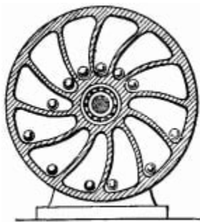
Рис. 45. Мнимый вечный двигатель с перекатывающимися шариками.
