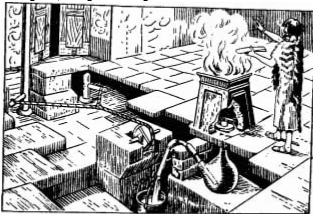
Рис. 74. Разоблачение “чуда” египетских жрецов: двери храма открываются действием жертвенного огня.
