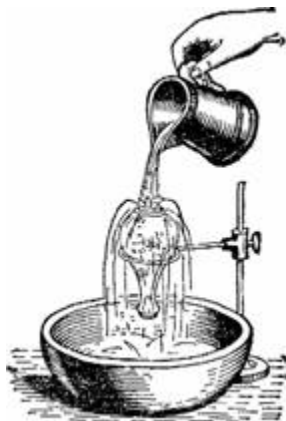
Рисунок 87. Закипание воды в колбе, обливаемой холодной водой.
