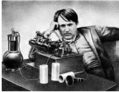
5 Edison an seinem verbesserten Phonographen von 1888 mit Hörern im Ohr. Links Batterie, vorn Wachswalzen
