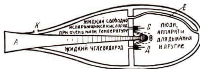
Abb. 31. Ziolkowskis Rakete von 1915, Zeichnung von K. E. Ziolkowski Inschrift links oben: flüssiger, frei verdunstender Sauerstoff bei sehr niedriger Temperatur; links unten: flüssiger Kohlenwasserstoff; rechts: Menschen, Apparate für die Atmung und anderes
