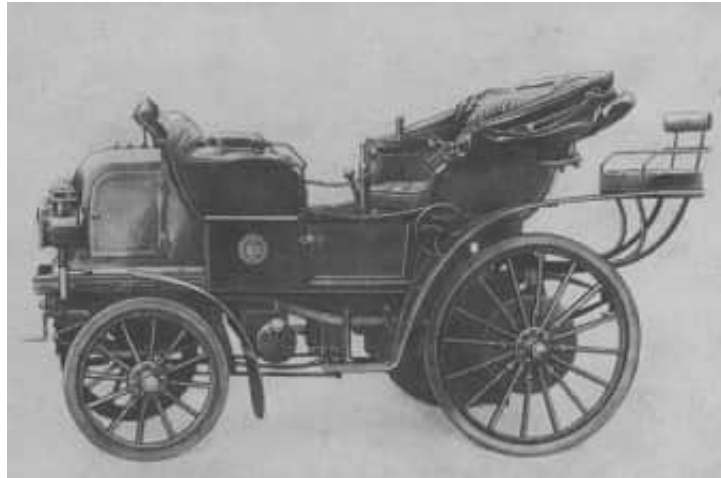
13 Der Zweizylinder-Phönixmotor trieb diesen Daimler-Wagen erstmals von vorn an (1897). Mit der Blechhaube über dem Motor deutet sich ein Charakteristikum des Kraftwagens an
