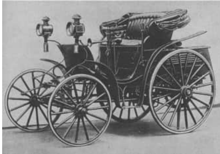
6 Der Benz-"Victoria" (1893), der von einem 2,9-l-Einzylindermotor mit senkrechtem Schwungrad angetrieben wurde; mit einem solchen Wagen ging Baron von Liebig auf seine berühmte Reise
