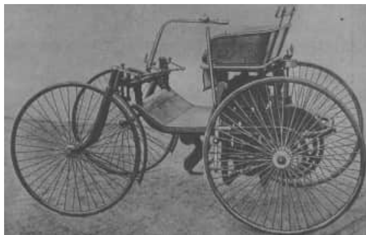
12 Das Fahrrad stand Pate bei der Entwicklung dieses Kraftwagens, des sog. Stahlrad-Wagens (1889); Rahmen-Rohr-Konstruktion, die Lenkung und natürlich auch die Klingel auf dem Lenker weisen deutlich darauf hin
