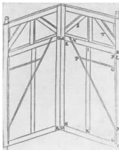
24 Schema eines Schleusentores, das wahlweise zum Betrieb einer Kammer- oder Spülschleuse benutzt werden kann [17]
