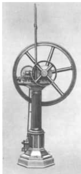
Abb. 4. Die auf der Pariser Weltausstellung von 1867 gezeigte Atmosphärische Gasmaschine von N. A. Otto und E. Langen
