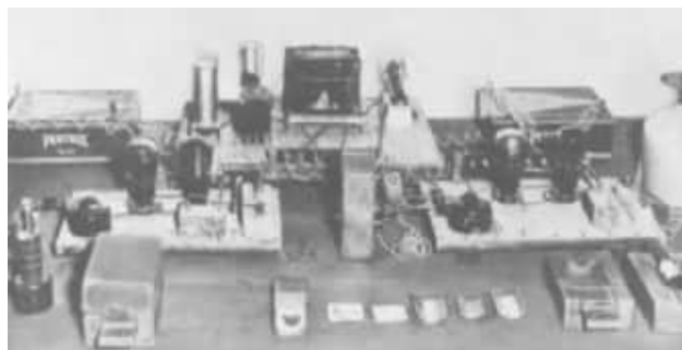
9 Versuchsanordnung, mit der im Dezember 1938 von Otto Hahn und Fritz Straßmann die Kernspaltung nachgewiesen wurde
