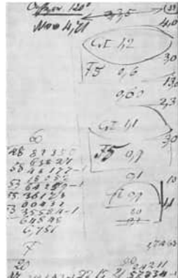
22 Konstruktionsskizze für das stärkste Trockensystem F vom 4. November 1871, Sammellinsen jeweils aus Kron- (Cr I). Zerstreuungslinsen jeweils aus Flintglas (F 5). Zahlenangaben in Millimetern (!).
