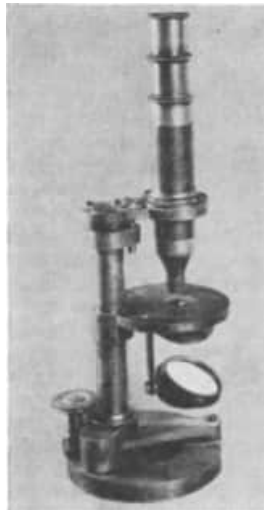
12 Zusammengesetztes Mikroskop Nr. 9 von Carl Zeiß aus dem Jahre 1858 (Standort: Optisches Museum der Carl-Zeiss-Stiftung Jena), (nach [114, S. 16 f.] )
