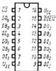
Bild 5.2.6 Anschlußbelegung des Bustreibers DS8216
