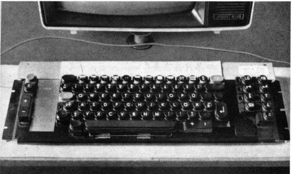
Bild 5.5 : Komforttastatur für KC85/2 und KC85/3 (mit eingebautem U807D); a – benutzter Teil mit provisorischen Tastenaufklebern und Informationsleiste, b – Gesamtansicht mit reserviertem Tastenblock
