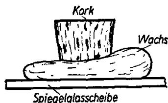
a) Herstellen des Versuchskörpers aus Kork und Wachs
