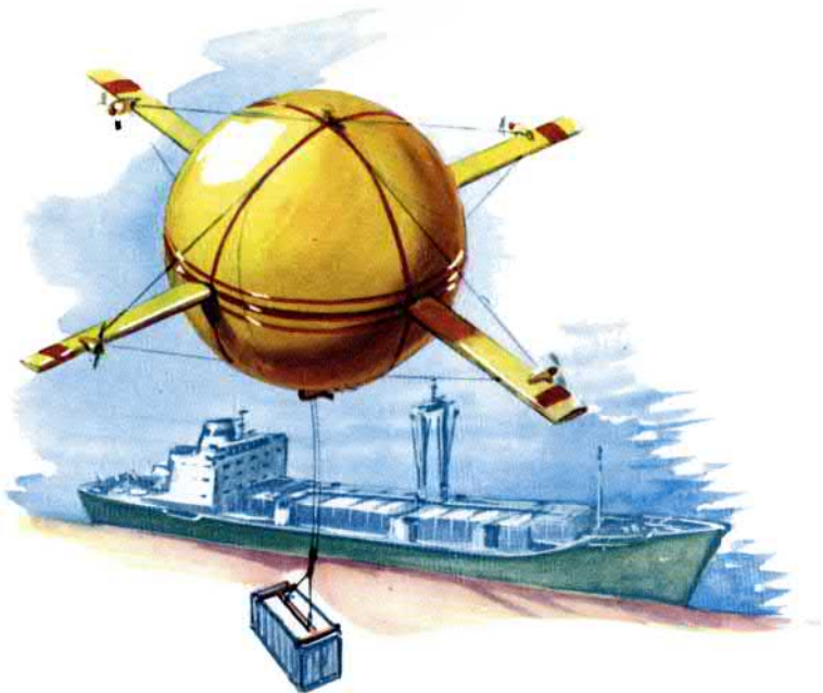
Lenkbarer Ballon als Transportmittel und Montagegerät im Freien und in großen Werkhallen (Aerocrane)
