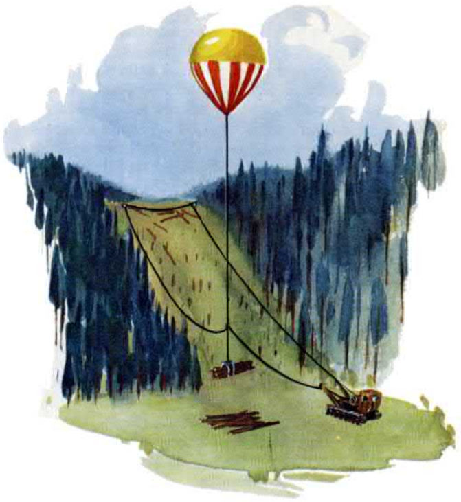
Holztransport mit Hilfe eines Fesselballons an Hängen und in unzugänglichen Schluchten
