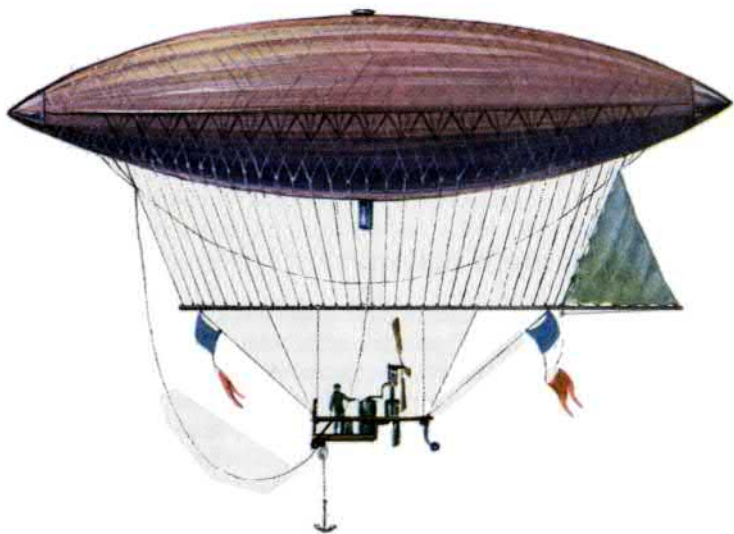
Giffard verwirklichte 1852 zum ersten Mal das Prinzip des lenkbaren Ballons, der erstmalig auch mechanisch (mit Dampf) angetrieben wurde.
