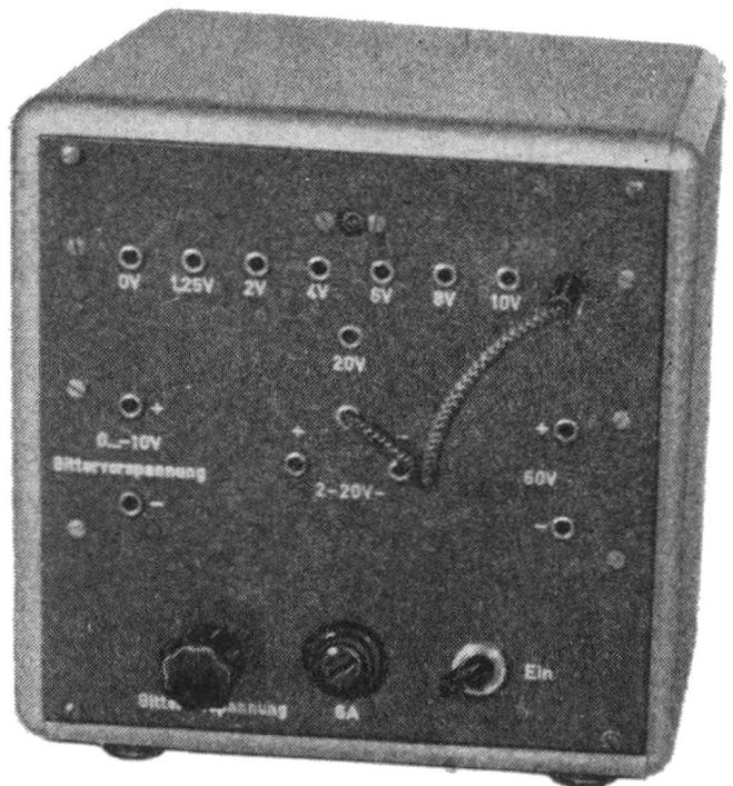
Abb. 258 Stromversorgungsgerät mit direkter Spannungswahl
