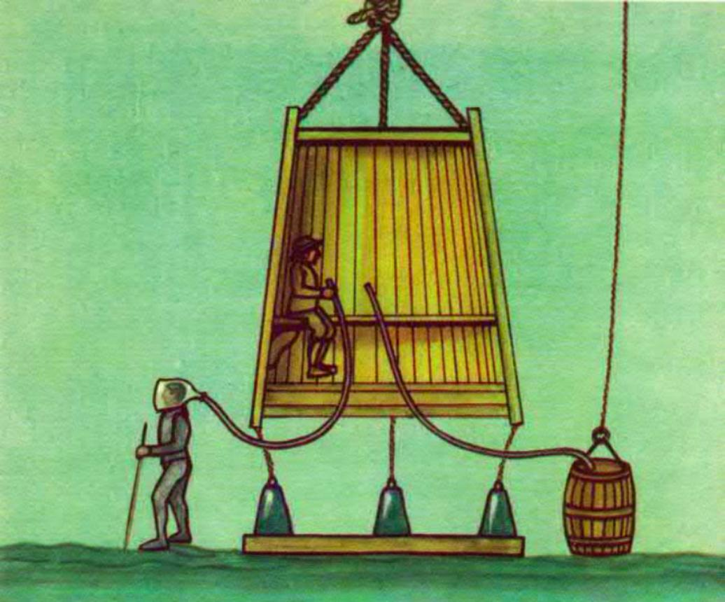
*Halleys Vorschlag einer zusätzlichen Luftversorgung für Taucherglocken*
