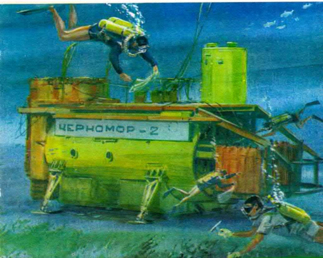
nutzbare Innenraum von 2 m Höhe ist in eine Taucherzelle (mit Ausstiegsluken), eine Wohn- und Arbeitszelle und eine Sanitärzelle geteilt. Eine transportable Druckkammer dient dem Austausch der Besatzung.
