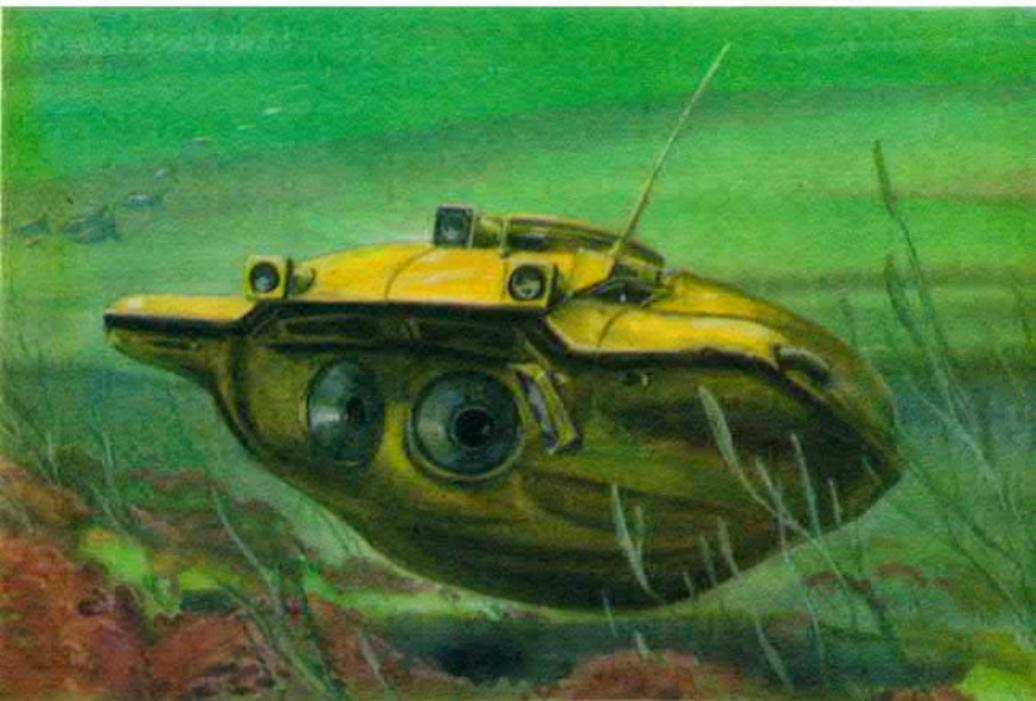
günstig herausstellte. Um den Druckkörper befinden sich unter einer ringförmigen Fiberglasverkleidung die Antriebsaggregate, Batterien und anderes Zubehör. 1958 wurde der erste Druckkörper erprobt.
