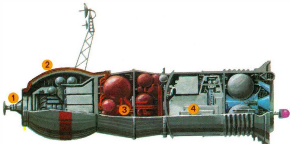
*Sowjetisches Einweg-Transportraumschiff »Progress 1«, durch dessen Einsatz die Lebensdauer von Raumstationen wesentlich erhöht werden kann. 1 – Kopplungsadapter mit Anschlußstücken für die Tankleitungen; 2 – Nachtankleitungen; 3 – Frachtsektion mit Kraftstoffbehältern, Behältern für Druckgas und Stickstoff sowie Pumpen und anderen Geräten; 4 – Gerätesektion mit Antrieben und automatischer Steuerungsanlage*
