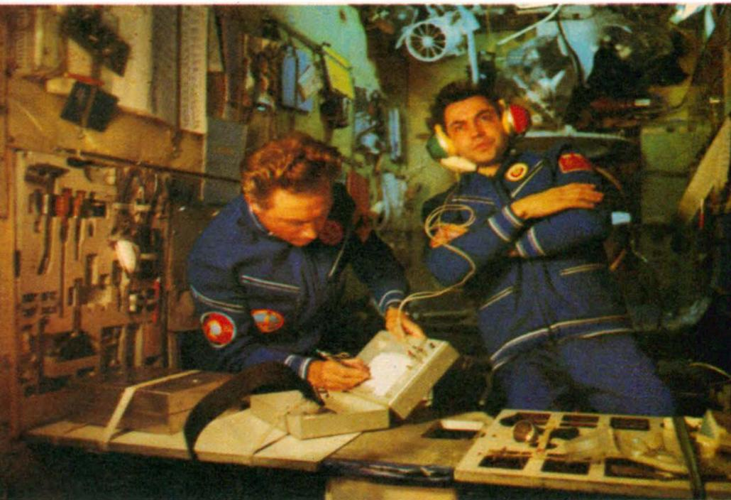
*Sigmund Jähn und Alexander Iwantschenkow in »Salut 6« beim Experiment »Audio«. Im Bild ist deutlich erkennbar, daß alle Gegenstände durch Befestigungsgurte an ihren Plätzen gehalten werden. Im Hintergrund befindet sich an der Decke der Station einer der Ventilatoren, die für einen Umlauf der Atemluft zu sorgen haben.*
