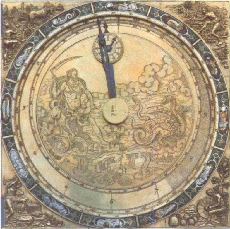
*Saturntafel und Gesamtansicht der Planetenlaufuhr von E. Baldewin und H. Bucher (1563–1567). Diese Uhr ist eine der prunkvollsten und technisch ausgereiftesten astronomisch-astrologischen Schauuhren, die neben der Zeit auch kalendarische Daten sowie den Lauf der Planeten anzeigen.*
