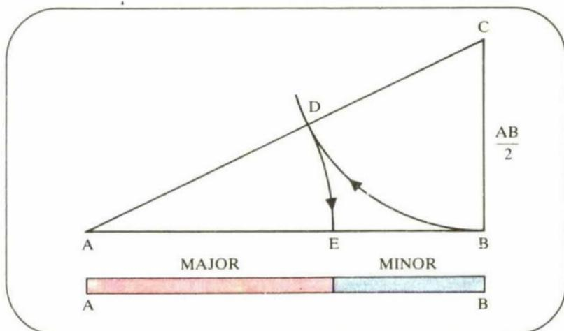
*Darstellung des Konstruktionsschemas für den Goldenen Schnitt. Im Bild ist die ganze, ungeteilte Strecke durch AB gegeben. Die halbe Länge wird senkrecht nach oben im Punkt B abgetragen und führt zum Punkt C. Seine Verbindung mit A liefert die Diagonale. Ein Kreis um C mit der Länge  $\frac{AB}{2}$  führt auf ihr zum Schnittpunkt D, ein Kreis um A mit dem Radius AD ergibt auf der Grundlinie den Schnittpunkt E. Jetzt sind AE die längere und BE die kürzere Strecke.*
