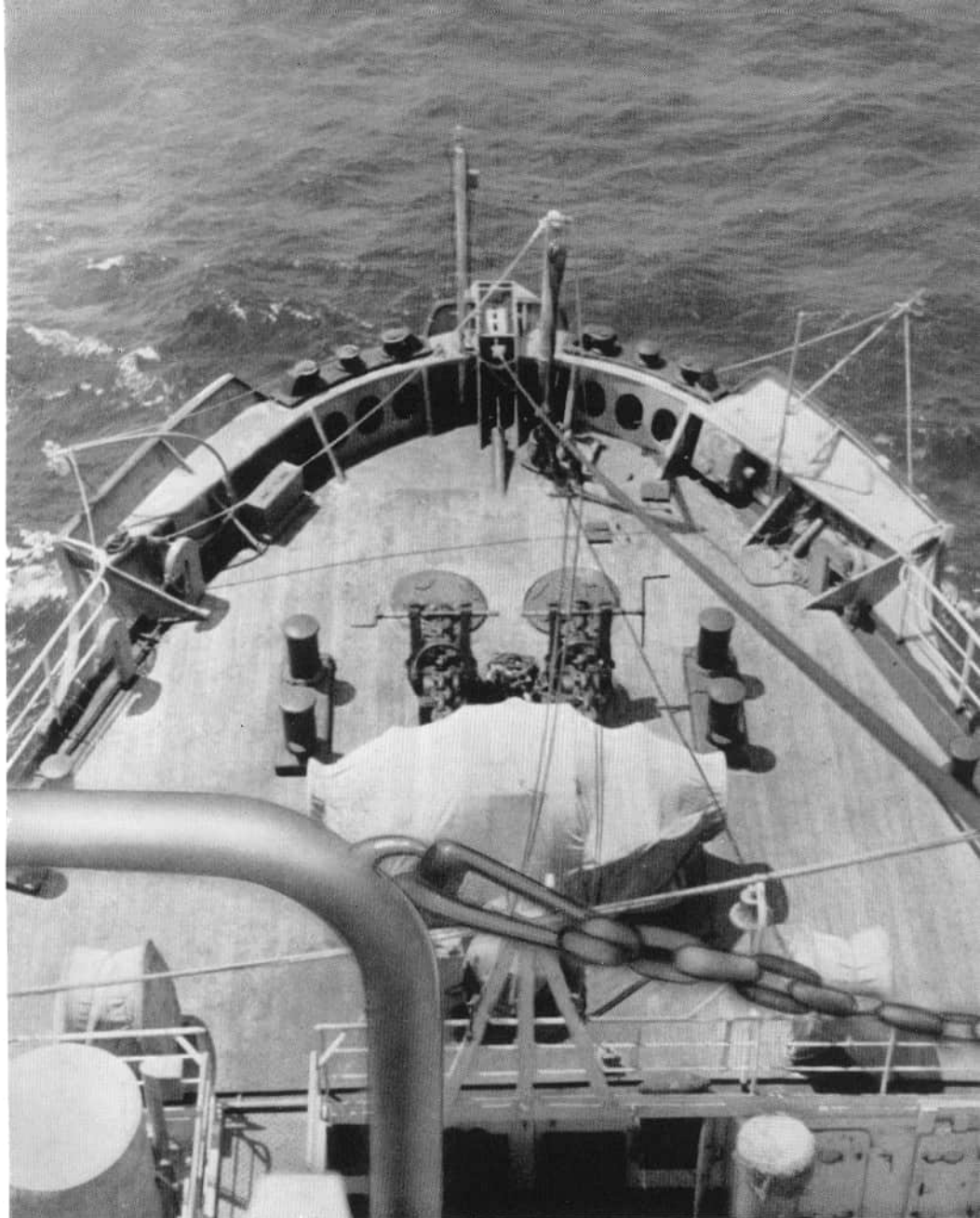
Blick von der Saling auf das Vorschiff; links der Ausleger mit den Strahlungsmessern
