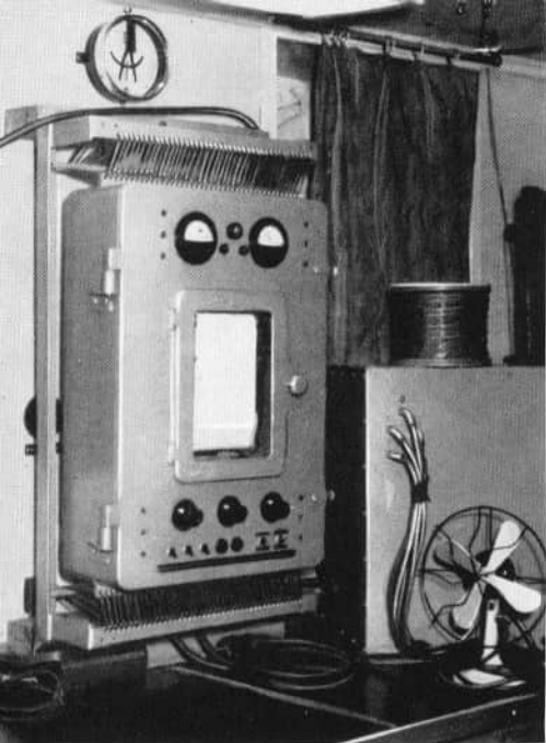
Registrierinstrumente im Labor: links für den Wellenmesser, rechts für den großen Strömungsmesser. – Die Ecke der Meteorologen in unserem Labor: Meßbrücke, Kompensator und Chronograph (unten)
