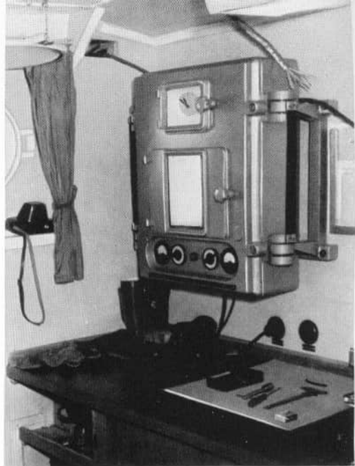
Registrierinstrumente im Labor: links für den Wellenmesser, rechts für den großen Strömungsmesser. – Die Ecke der Meteorologen in unserem Labor: Meßbrücke, Kompensator und Chronograph (unten)
