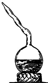
Abb. 6 Nach dem Abtöten der Keime zugeschmolzener Pasteurscher Kolben
