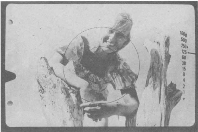
Analoge Belichtungszeitanzeige (Praktica EE 3)
