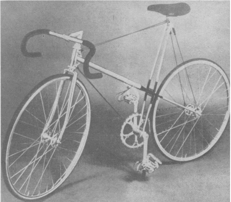
Fahrrad mit verspanntem Rahmen
