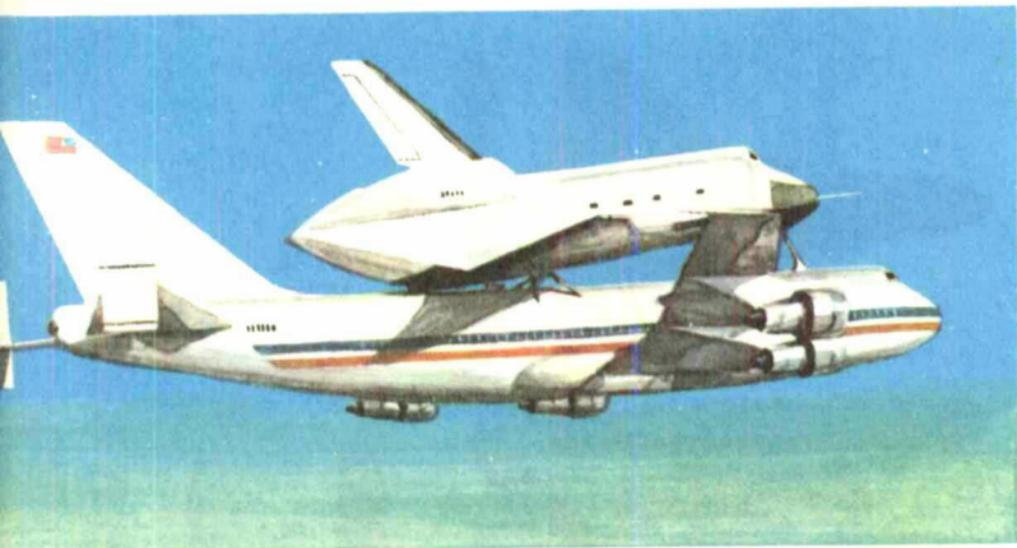
*Über der Mojave-Wüste Kaliforniens wurde im Jahre 1977 die Enterprise auf dem Rücken eines Jumbo-Jets (B 747) mehrmals in 6 000 bis 8 000 m Höhe geschleppt. Der Raumtransporter kehrte dann auf kurzen »Gleitflügen« zur Landepiste zurück.*
