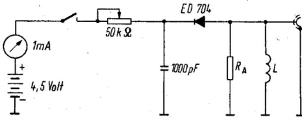
Bild 7. Rauschgenerator mit Kristalldiode
