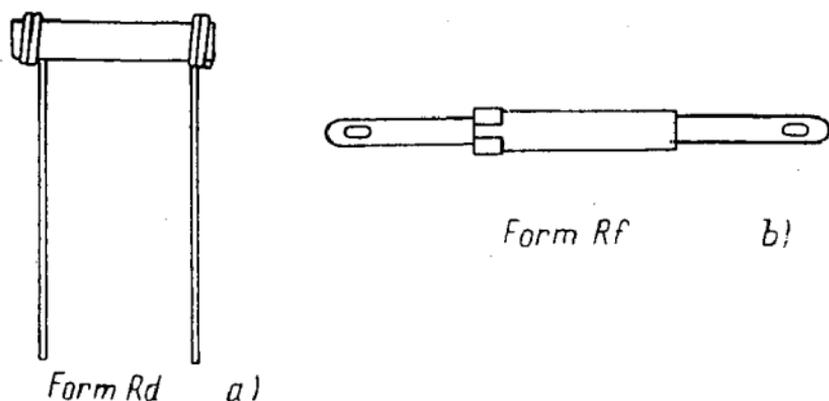
Bild 13. Rohrkapazität. a) mit Drahtenden; b) mit Anschlußfahnen
