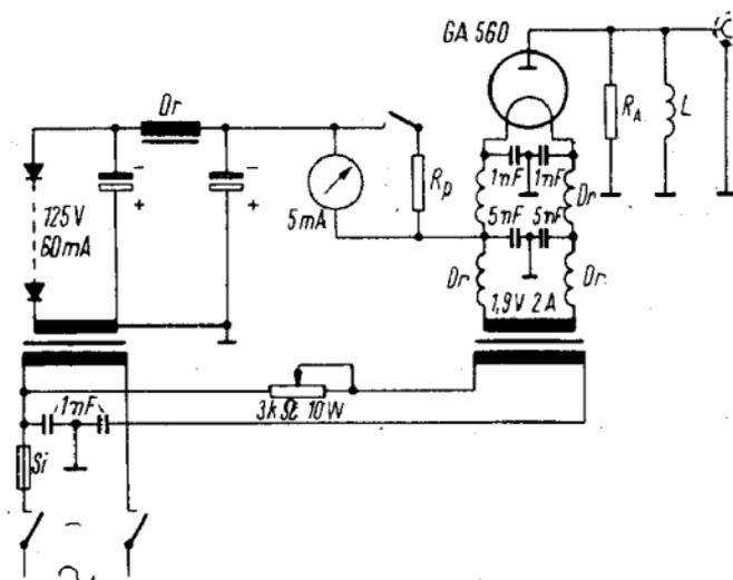
Bild 8. Rauschgenerator für den anspruchsvollen UKW-Amateur
