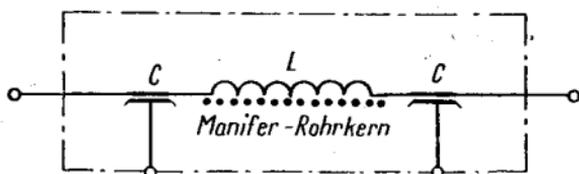
Bild 21. Prinzipschaltbild eines Durchführungsfilters
