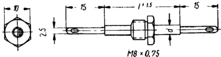
Bild 18. Durchführungsrohrkondensator mit Schraubbefestigung
