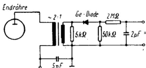
Bild 11. Meßeinrichtung für die NF-Ausgangsspannung
