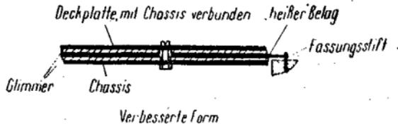
Bild 12. „Klatschkondensator“
