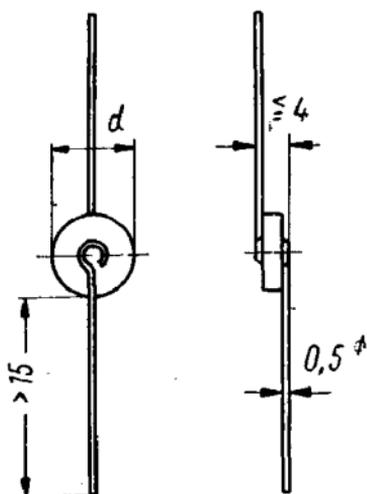
Bild 15. Scheibenkondensatoren
