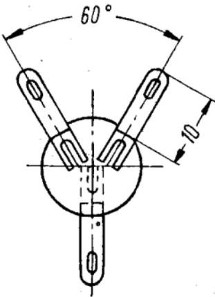
Bild 16. Mehrfachscheibenkondensatoren
