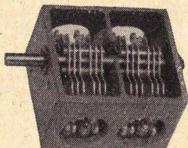
Bild 20. Zweifach-Split-Stator-Drehkondensator.
