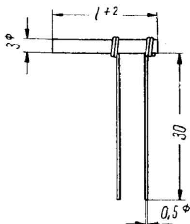
Bild 14. Miniaturkondensatoren mit Drahtenden
