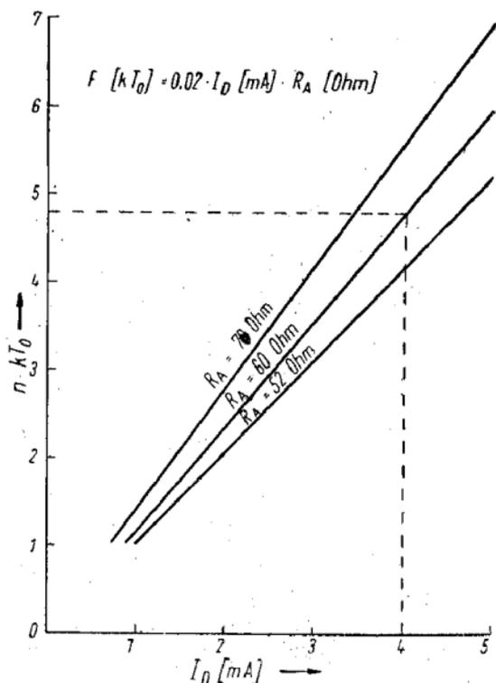
Bild 10. Diagramm zum Ablesen der Rauschzahl
