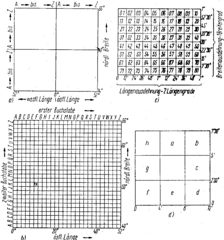
Bild 31. Der QRA-Kenner. a) Aufbau; b) Großfläche mit 576 Mittelfeldern; c) Kleinfeld; d) Kleinstfeld
