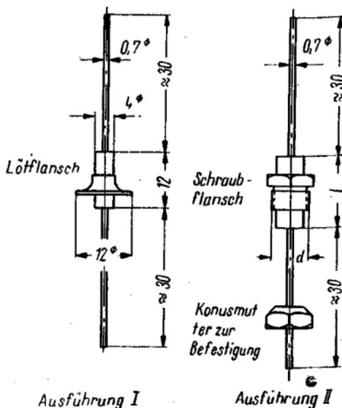
Bild 22. Durchführungsfilter
