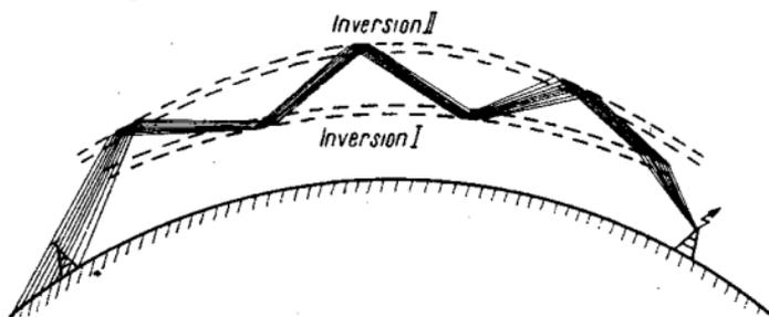
Bild 4. „Schlauchübertragung“ zwischen zwei Inversionsschichten
