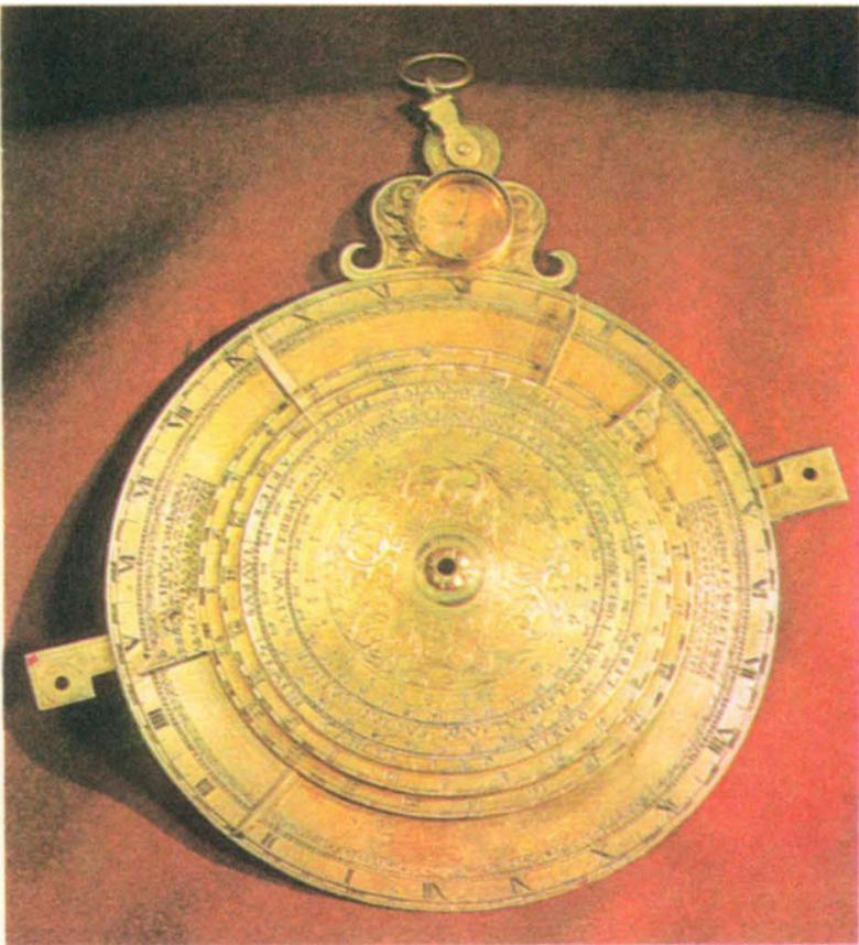
*Mittelalterliches Astrolabium, ein Gerät, das zur Bestimmung der Planetenörter diente*
