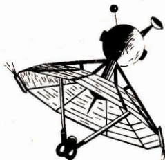
▲ Abb. 7: Regenschirmförmiges Sonnensegel nach einem Vorschlag von Cotter, Archiv Naumann.
