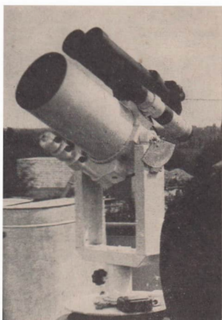
Abb. 5: Tachar-Kamera zur fotografischen Vermessung von Satelliten.
