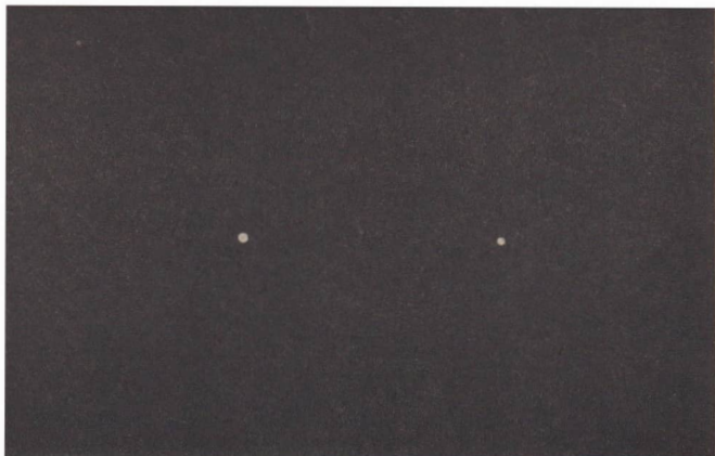
Abb. 4: Nachweis des Schwarzschildeffekts. Aufnahmen eines künstlichen Sterns mit unterschiedlichen Öffnungen und entsprechender Belichtungsverlängerung. Obwohl die zweite Aufnahme mit 1/64 Objektivfläche 64mal länger belichtet wurde, entsteht keine Schwärzungsgleichheit.
