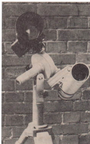
Abb. 1: Diese astrofotografische Anlage kam während der 11. Weltfestspiele in Cuba zum Einsatz. Polhöhe ist auf 23 Grad eingestellt.
