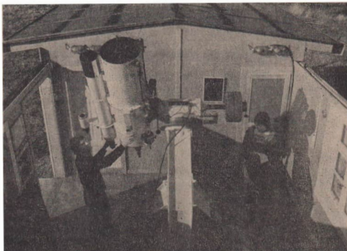
Abb. 2: Tagesbeobachtung der Venus am 30-cm- Spiegelteleskop, das von einem über Fre- quenzgenerator ge- speisten Synchron- motor angetrieben wird. Motorische Grob- und Feinbewe- gungen für beide Ko- ordinaten sind vor- handen.
