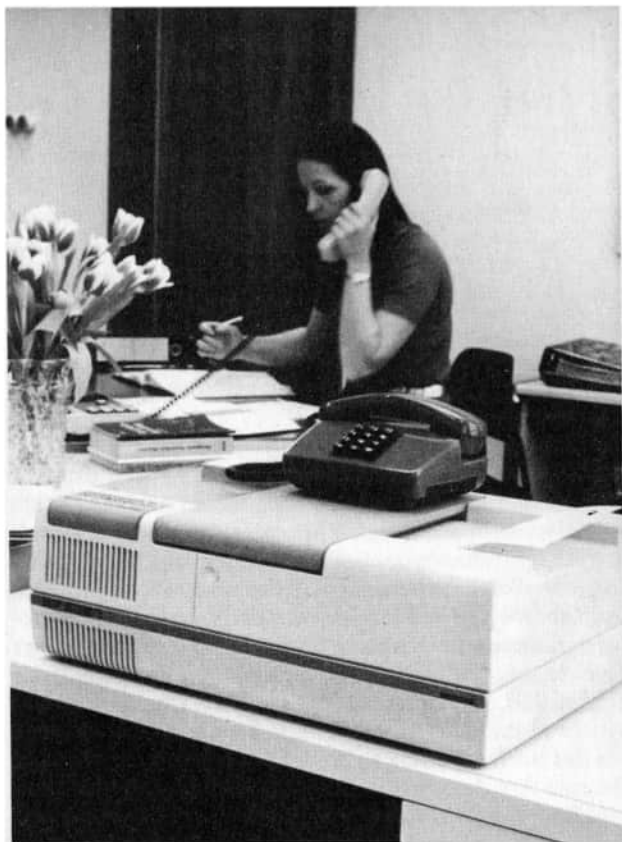
Sende/Empfangsgerät für Fernkopien. Der Empfangsbetrieb läuft vollautomatisch ab, auch bei unbesetzter Empfangsanlage.
