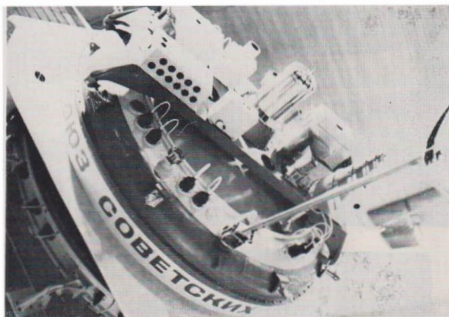
Abb. 3: Meßinstrumenten- anordnung eines Satelliten der Prognos-Serie.
