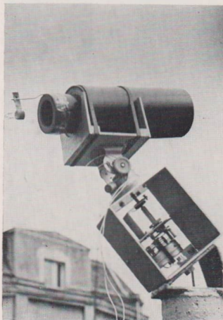
Abb. 2 (li.) und 4 (re.): Montiertes Photometer am Beobachtungsinstrument 76,5/285 mm.
