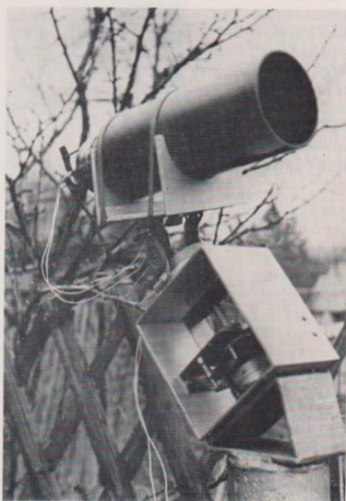
Abb. 2 (li.) und 4 (re.): Montiertes Photometer am Beobachtungsinstrument 76,5/285 mm.
