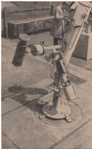
Abb. 3 Das 200-mm-Spiegelteleskop mit einem Astrographen (Foto: Rudolf Drößler)
