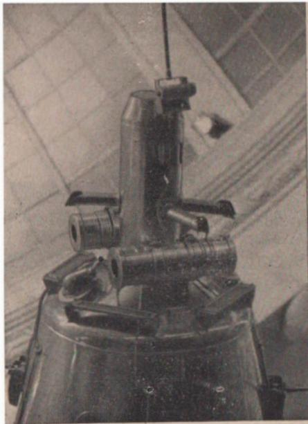
Abb. 20 Das Magnetometer und die zwei Meßgeräte für die Korpuskularstrahlung der Sonne an der Spitze von Sputnik 3 (Aufn.: K. H. Neumann)
