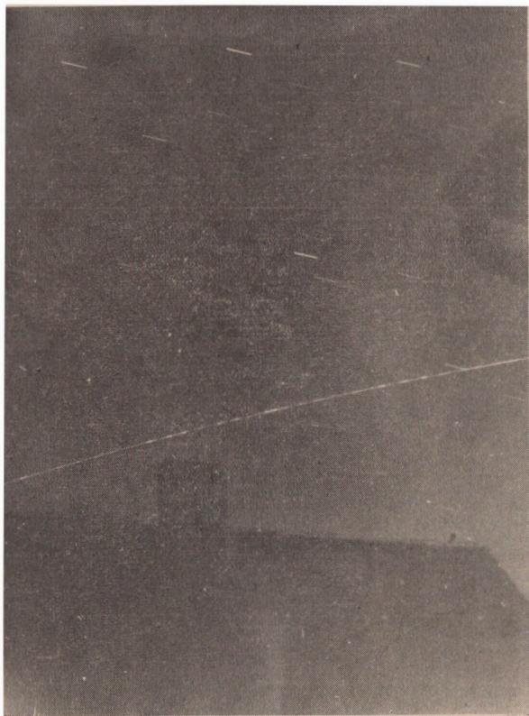
Abb. 1. Fotografische Aufnahme des amerikanischen Erdsatelliten Echo I. Instrument: Weltaflex mit Rectan 1 : 3.5, f: 75 mm auf Umkehr-Rapid 25/10 DIN-Film.
