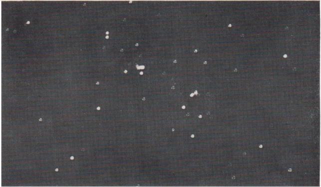
Abb. 8: Extrafokale Sternfeldaufnahme zur Überprüfung der Lage der Korrekionsplatte; Vergrößerung 12fach.
