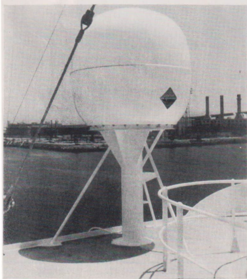
Abb. 8: Radom zum Schutz der Schiffsantenne an Deck.
