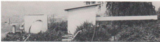
Abb. 1: Spektrohelioskop (Gesamtansicht), v. l. n. r.: Horizontalcoelostat mit zurückgefahrener Schutzhütte, – Beobachterhäuschen, – Spektroskopverkleidung.
