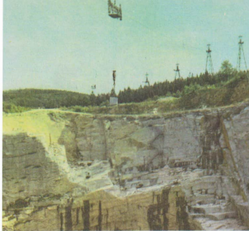
Abb. 21. Steinbruch im Westlausitzer Granodiorit im Klosterberg bei Demitz-Thumitz (Lausitz). Die für granitische Gesteine typische bankige Absonderung kommt deutlich zum Ausdruck.
