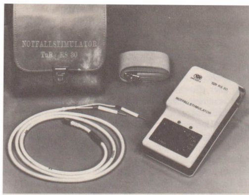
Notfall-Stimulator TuR RS 30 zur Reaktivierung der Herztätigkeit durch externe Elektrostimulation. Die Sonde mit den Elektroden wird in Nase oder Mund geschoben; der batteriegespeiste Impuls-generator erzeugt Pacemaker-Impulse von etwa 1,5 ms mit den Frequenzen 70, 90 und 100 Imp./min.
