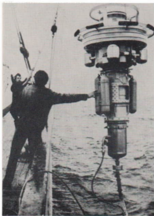
Abb. 5. u. 6.: Aussetzen spezieller Meßbojen für hydrologische Forschungen mit dem SDS vom Typ SSPI.
