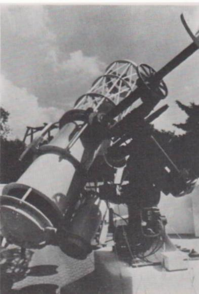
**Amateursternwarte Greßmann mit Hauptinstrument Cassegrain 450/7650, Leitrohr 230/1500 (Newton) und diversen Schmidt-Kameras (u. a. 340/400/760). Alle Instrumente entstanden im eigenen Betrieb.**
