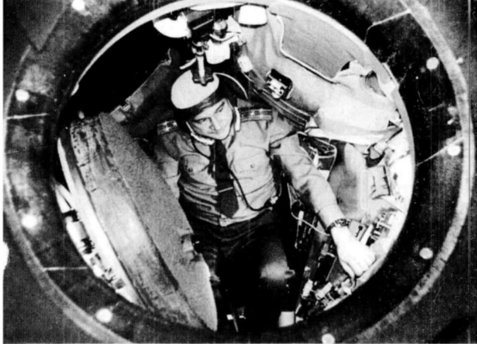
*Durchstiegs Luke zwischen der »Sojus«-Kommandokabine und der Orbitalsektion*
