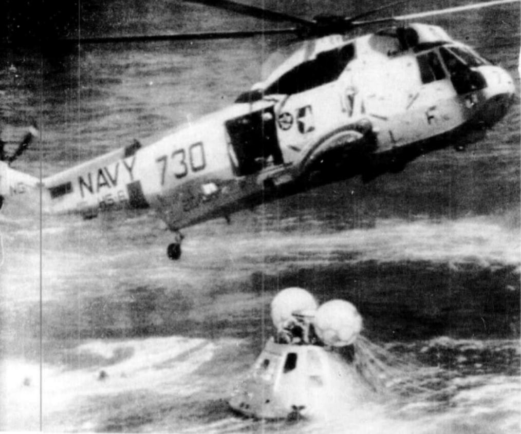
*Bergungshubschrauber über der »Apollo«-Landestelle, nachdem der Kapsel von Froschmännern Schwimm-Manschetten angelegt worden waren und zwei Ballons die mit der Spitze zuerst aufgetroffene Rückkehrkabine wieder aufgerichtet hatten*
