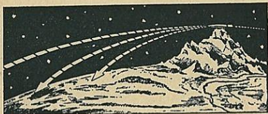
Abb. 3 Mit zunehmender Geschwindigkeit nimmt die Flugweite zu und die Krümmung der Flugbahn ab. Wenn die Rakete die Kreisgeschwindigkeit erreicht hat (oberste Flugbahn), fliegt sie parallel der Erdoberfläche und wird zum Trabanten der Erde
