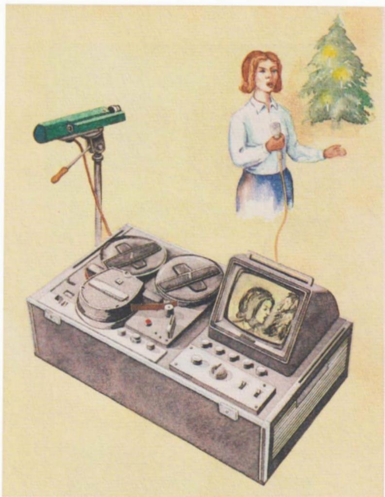
*Videospeichergerät mit Kontrollbildschirm und Aufnahmekamera zur Aufnahme und Wiedergabe eigener Video- und Tonbandproduktionen über das Heimfernsehgerät sowie auch von Sendungen der Fernsehstationen (japan. Produktion um 1971)*
