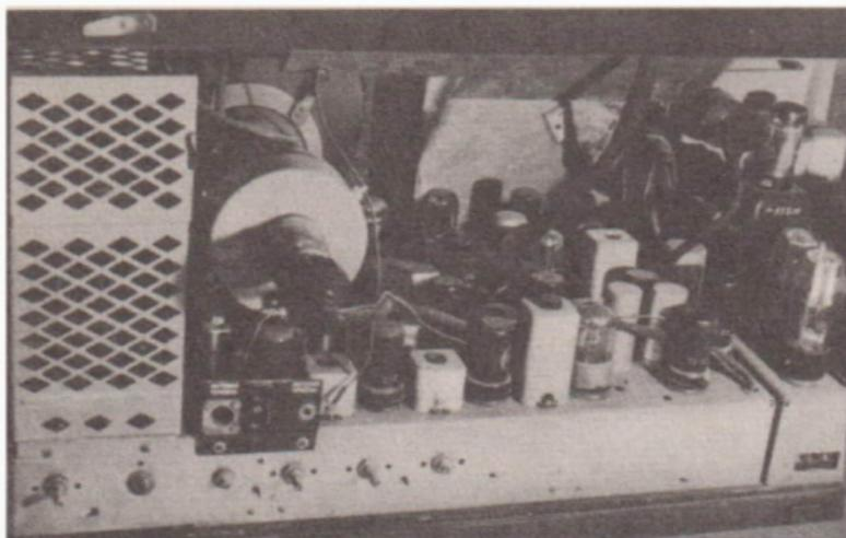
*Blick auf das »Innenleben« des ersten in der DDR produzierten Fernsehempfangsgerätes »Leningrad« (vgl. Abb. auf S. 70) mit der damals für Röhrenschaltungen typischen Chassisbauweise*
