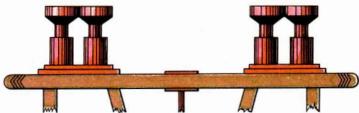
Anordnung unterschiedlicher Pufferpaare an einem Personenwagen
